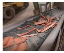
ベルトコンベアで運ばれた廃瓦を破碎機にかける。
