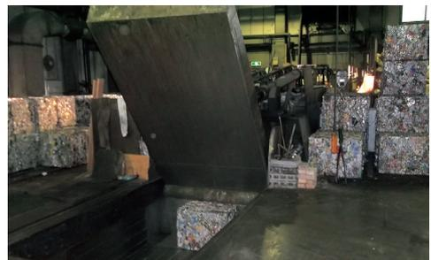
金属プレス機でスチール缶、アルミ缶を個別に圧縮成形します。
