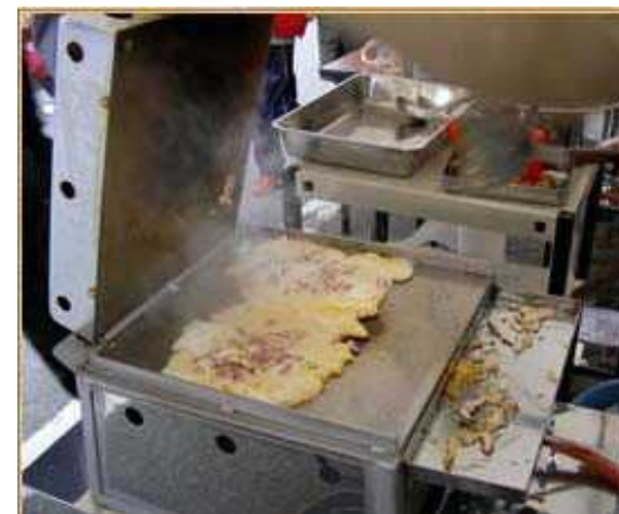
イカ焼き機 (様々な食材を素早く焼くことができる調理器具)
