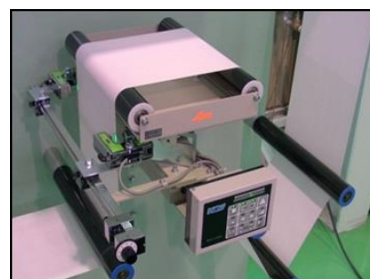
<炭素繊維を活用した製紙製造ラインを効率化する蛇行修正機>
