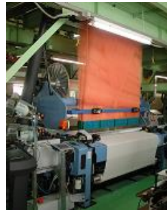
<生地製の織機試験や織り組織の生地試作に使用するタオル織機>
