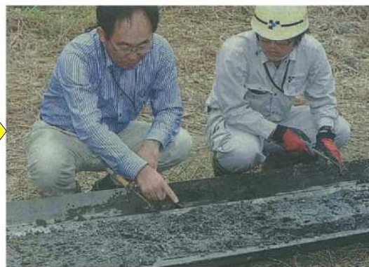
写真-2.1 地層試料採取の方法
