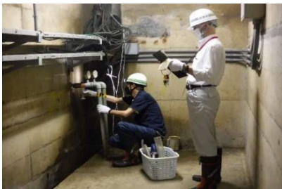
揚圧力の計測
