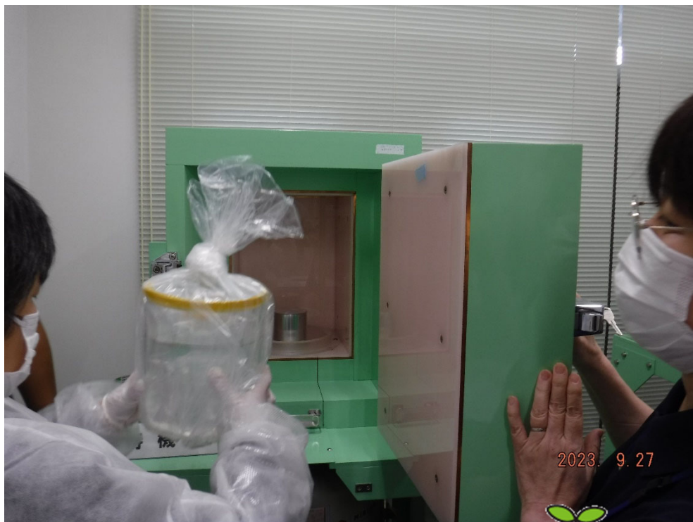
ゲルマニウム半導体検出器による放射能濃度測定 ①
