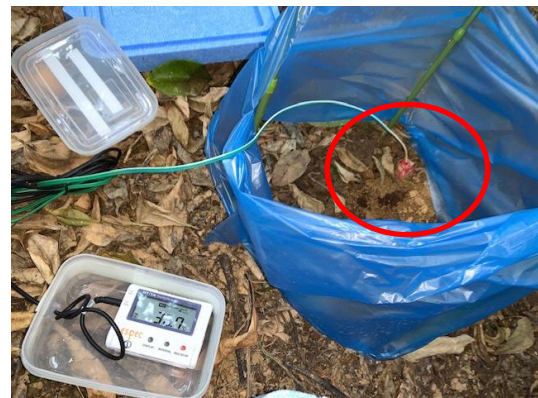
土壤水分センサーの設置 (○の地点にセンサーを埋設)
