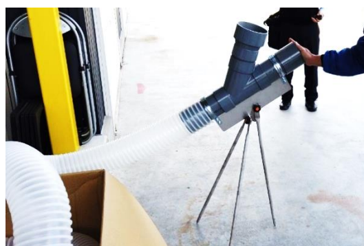
バキューム式果実搬送システム（投入側）
