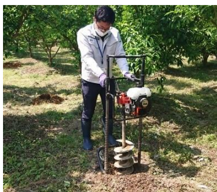
オーガでの掘削
