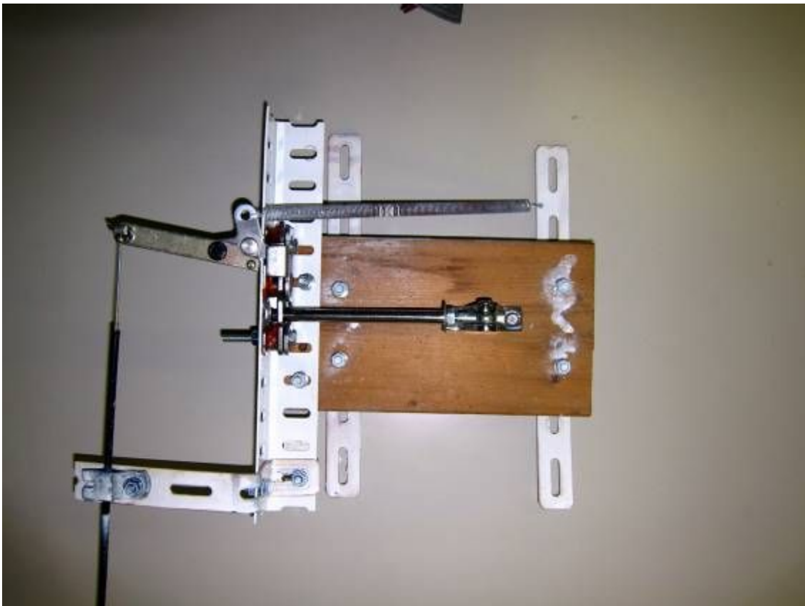
図 16 ドアラッチを用いたトリガー
