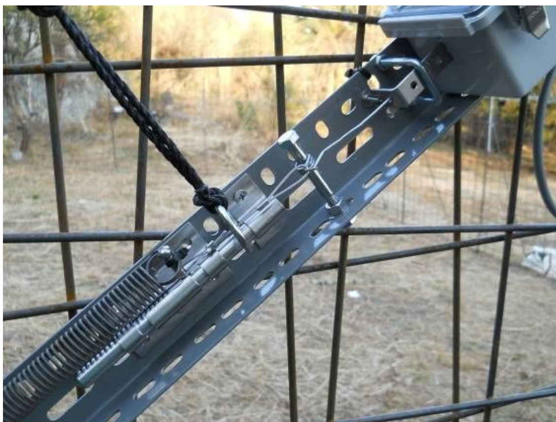
図 15 ステンレス落としを用いたトリガー
