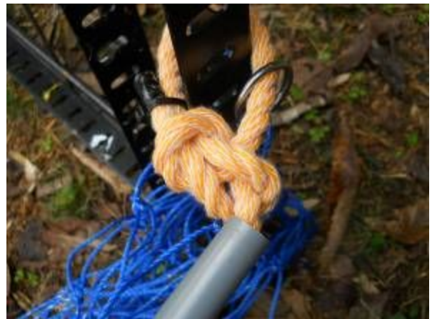
写真 9-5 引き上げ式ゲートの基部
