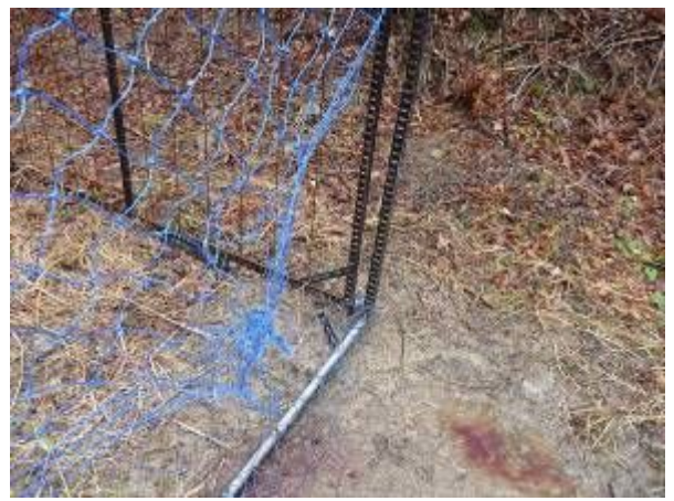
写真 14-5 捕獲個体が絡んでネットの一部が 断裂した状況(わな F)
