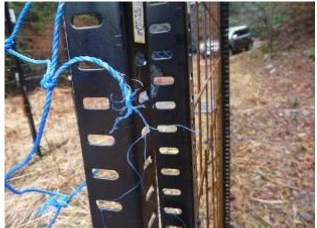
写真 14-6 L字アングルとの摩擦で擦り切れた ネットの断端(わな F)
