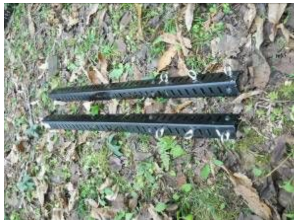
写真 10-6 L字アングルとアイボルトによるハンガー
