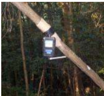
くくりわなに連結した「センサー」が捕獲を検知し親機へ
