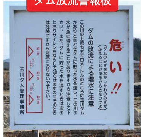
ダム放流警報板
