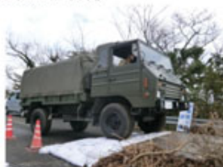
段差すりつけ (土のう使用)
