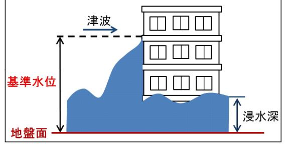
【地形(標高)データ】 〇 基準水位の算出に用いた「地形(標高)データ」は、平成25年度公表の津波 浸水想定図作成時に使用した地形である ため、その後の開発に伴う盛土や個別施 設の微細な土地の形状が現況と異なって いる場合があります。
