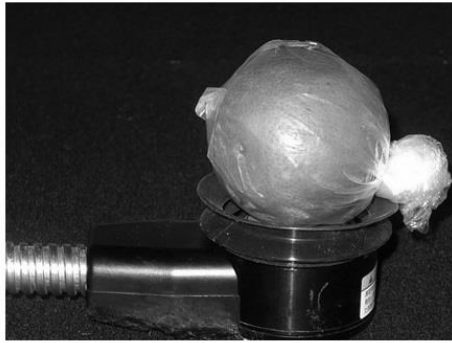
第1図 フィルム個装した‘タロッコ’の非破壊計測 可視・近赤外分光光度計の試料台に各種フィルムで個装した‘タロッコ’を静置
