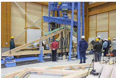
実大強度試験（公開）の様子
