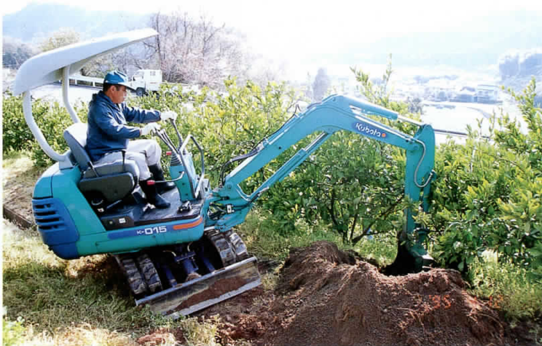
小型油圧式ショベルを利用したミカン苗木の移植
