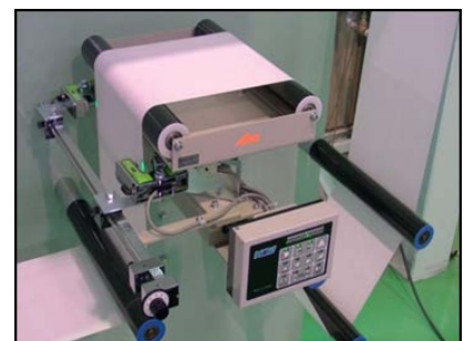
<炭素繊維を活用した不織布製造ラインを効率化する蛇行修正機>
