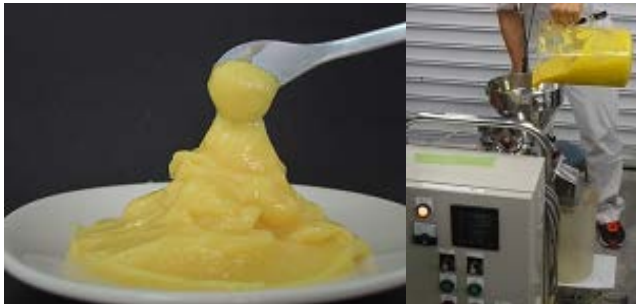
<愛媛が誇る柑橘の加工残渣を原料とした柑橘ナノファイバーと製造装置>
