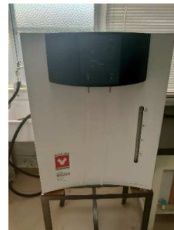
純水製造装置
