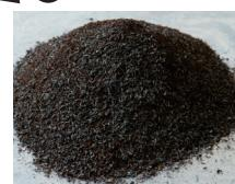
MazeMaze が生ごみの水分を吸収し、発酵を促進させる。
