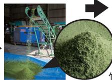
植織機で超微粒の竹粉末にする。1時間に1m<sup>3</sup>の粉末 (孟宗竹約 30 本分) ができる。
