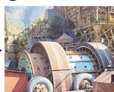
クリンカと山砂をあわせ、破碎、混合する。
