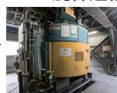
石炭灰・高炉セメント・消石灰を練り混ぜる。
