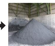
造粒・固化したものを1日静置し、完全に固化させる。
