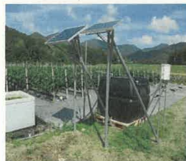
導入された自動灌水装置
