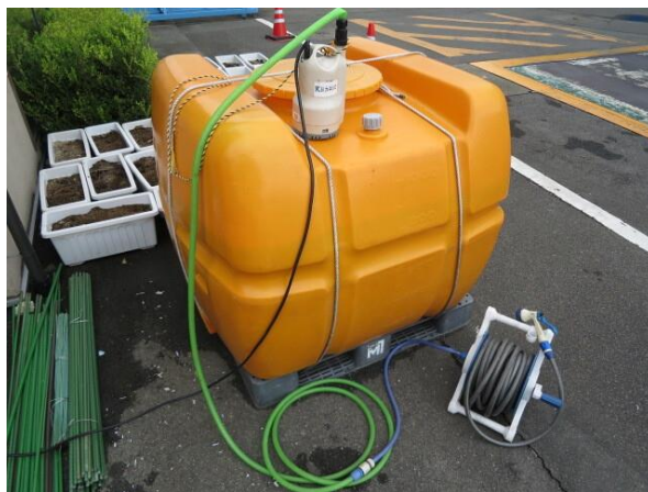
写真3. 散水設備 (0.6 m 3 タンクと水中ポンプ)
