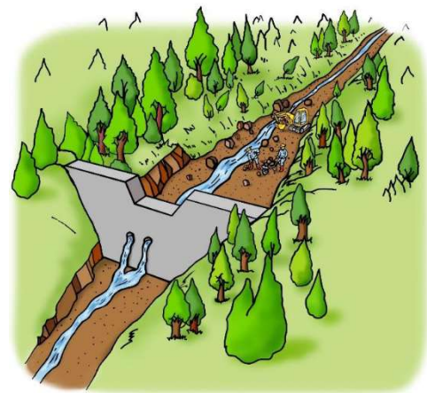
不透過型砂防堰堤
