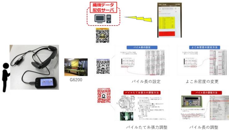
図 1 AR 技術を用いたタオル織機操作支援システム構成図
