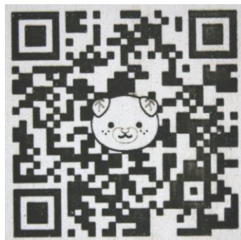
写真1 市販呉須から調整したインクでパッド印刷した QR コード
