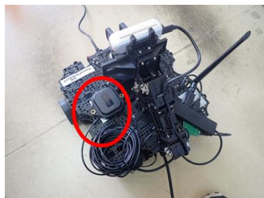
写真5 ロボットに載せた GNSS モジュール
