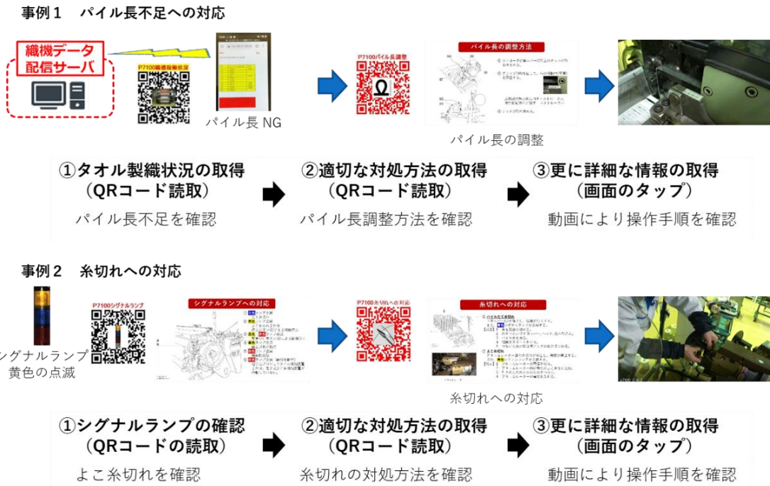
図4 システムにおける操作支援情報取得の流れ
