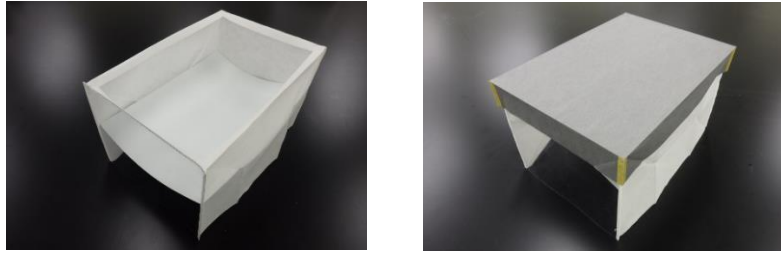
図1 加工状況（左：フィルターキャップ(上面開口) 右：活性炭紙設置状況）
