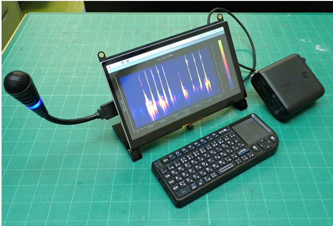
図4 Raspberry Pi を用いた音や振動の見える化機器
