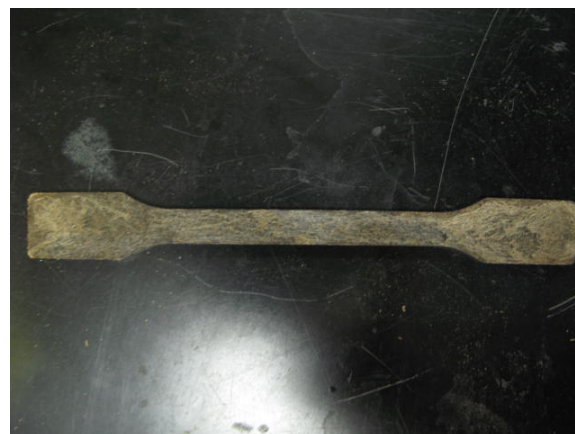
図4 青汁残渣混合樹脂ペレットで作成した引張試験用ピース
