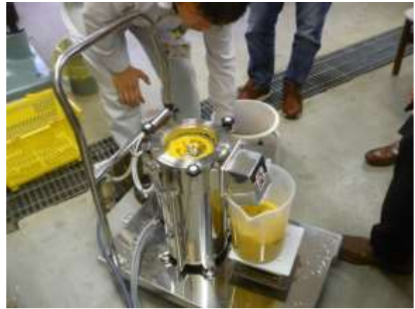
ディスクミルによる柑橘ナノファイバーの製造実験
