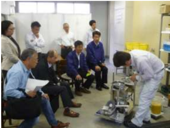
ディスクミルによる柑橘ナノファイバーの製造実験
