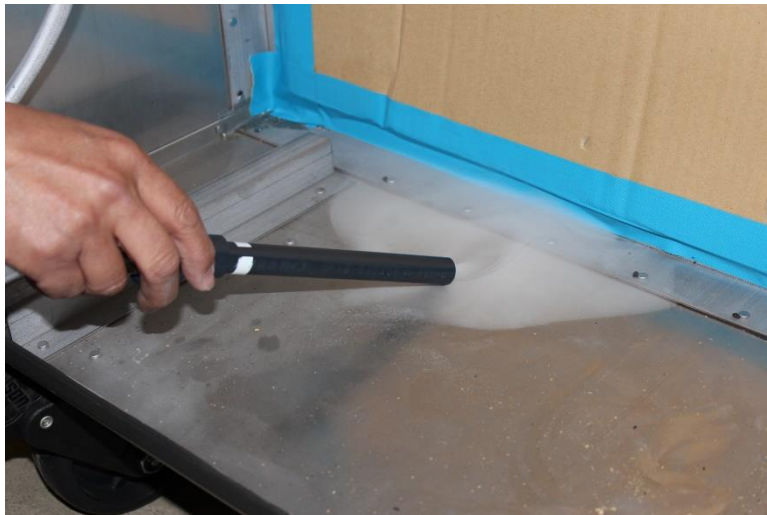
スモークテスターによる漏れの確認 HEPAフィルタ取り付け面の隙間から煙が吸い込まれていく
