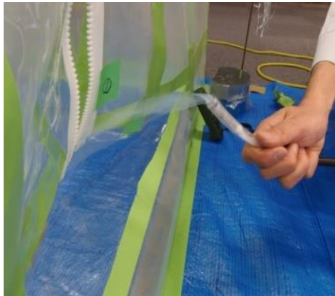
①前室が負圧に保たれていることの確認方法の例 (スモークテスターによる気流の確認)
