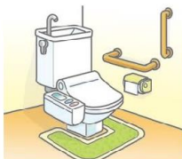
手すりの設置
