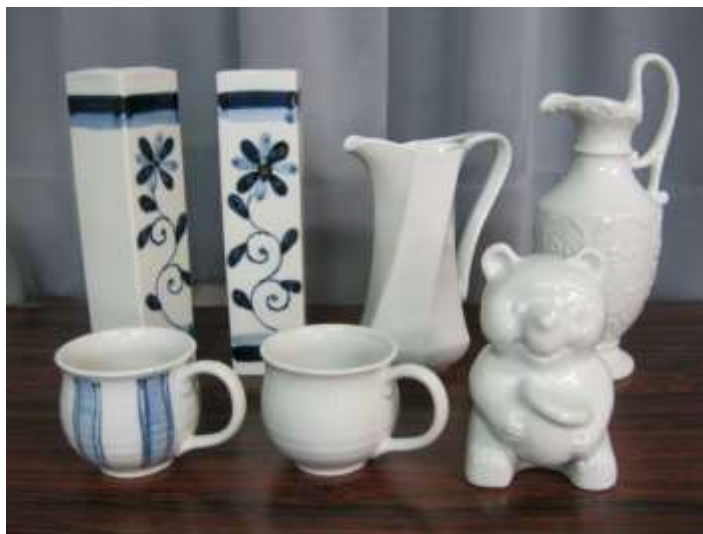
鑄込坏土を使用した試作品
