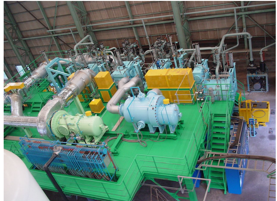
自社工場設置デモンストレーション用ホットガス式連続熱処理炉 （5室タイプ：前室、加熱室、第一冷却室、等温冷却室、第二冷却室）
